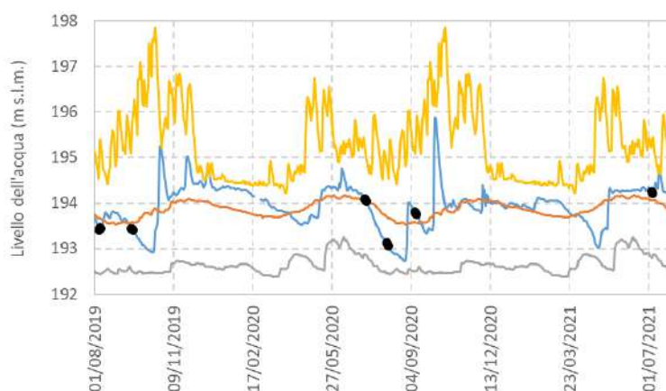
Figura 24 - Andamento medio (linea arancione), massimo (linea gialla) e minimo (linea grigia) tipico dei livelli giornalieri del Lago Maggiore unitamente al livello medio giornaliero evidenziato durante il progetto (periodo 1° agosto 2019 - 31 luglio 2021, linea blu) e date di campionamento (punti neri).
