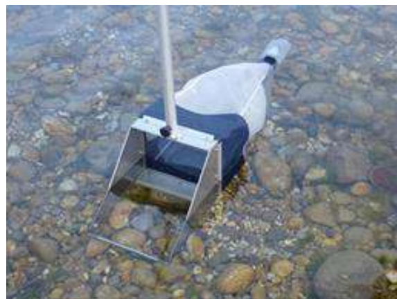
Fig. 2 - Sinistra: retino immanicato per raccolta di campioni di macrofauna, termometro da campo, bottiglia e imbuto utili al trattamento del campione in campo; destra: retino immanicato per raccolta di campioni di meiofauna.
