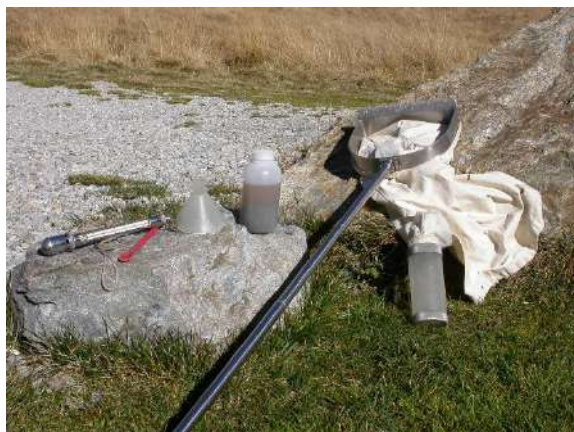
Fig. 2 - Sinistra: retino immanicato per raccolta di campioni di macrofauna, termometro da campo, bottiglia e imbuto utili al trattamento del campione in campo; destra: retino immanicato per raccolta di campioni di meiofauna.
