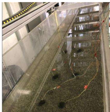
Fig. 12 - Esperimento di registrazione delle risposte comportamentali di Unio elongatulus in condizioni di simulazione delle variazioni naturali di livello e di movimento delle acque. Lo schema in alto e l'immagine sottostante illustrano la disposizione degli individui provvisti di sensori all'interno del fiume artificiale.
